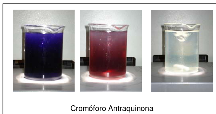
Figura 7.7.- Decoloración del Reactive Blue 4 en el proceso foto-Fenton
