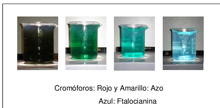
Figura 7.19.- Decoloración del baño mezcla de tres colorantes en simulador solar
