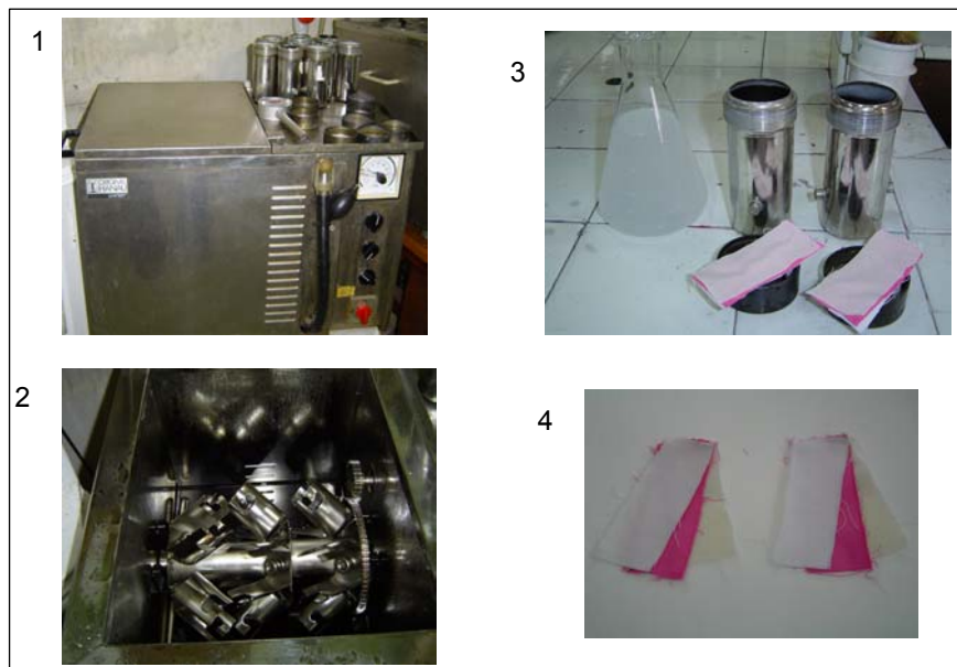
Figura 4.2- Linitest para la determinación de sólidos en húmedo. Recipientes y probetas
