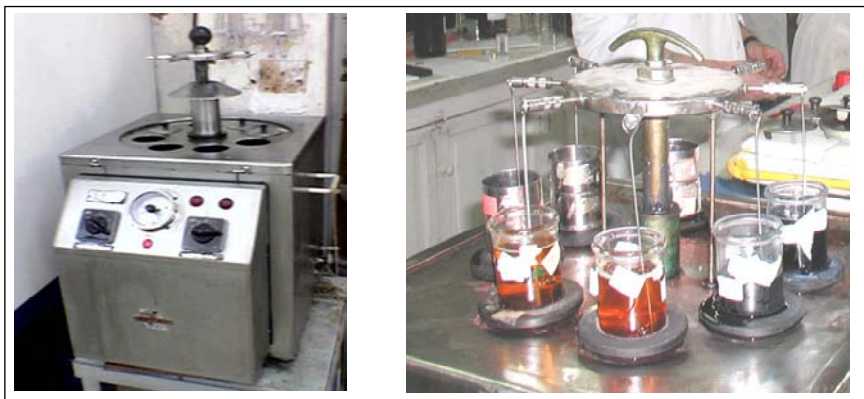
Figura 4.1- Equipos de tintura de laboratorio Tint-control de Renigal
