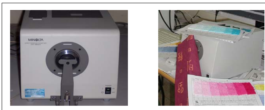
Figura 4.12- Espectrofotómetro de reflectancia
