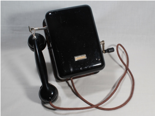
Figura 24. Teléfono ruso de batería local y llamada por magneto, del año 1930 (nº ref. 379).
