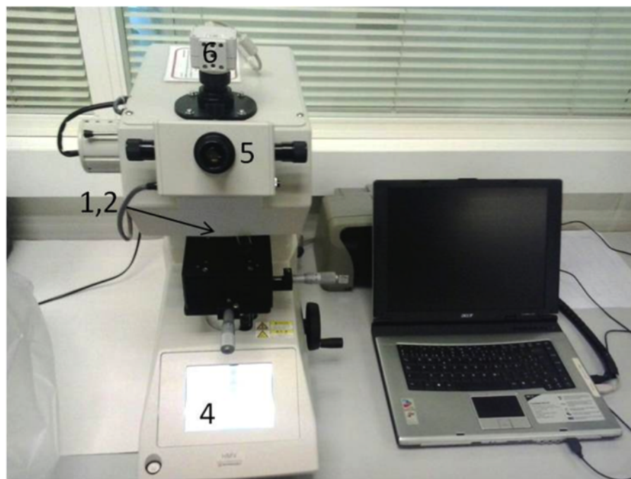
Figura 3: Microdurómetro con sistema de adquisición de imagen y control de ensayo mediante ordenador
