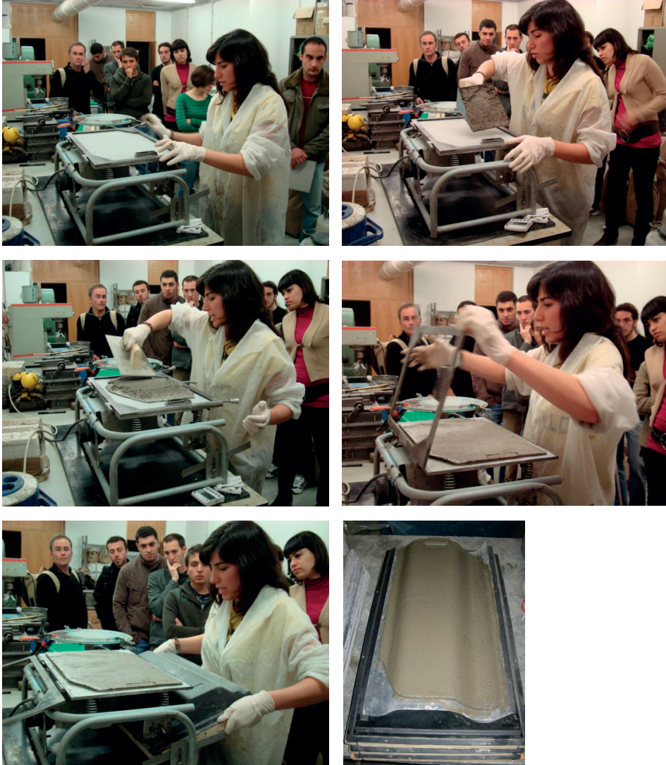
Figura 7.- Procedimiento para la elaboración de tejas de microconcreto utilizando la tecnología TeVI.
