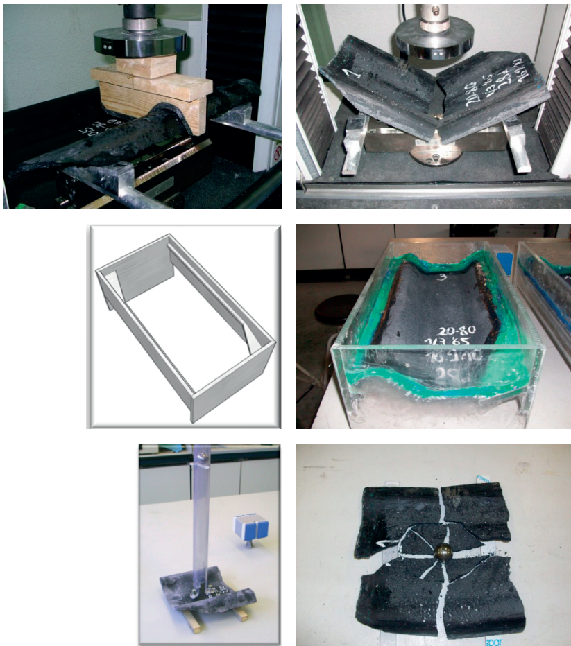
Figura 8. - Ensayo de carga a flexión, impermeabilidad y resistencia a impacto de las tejas TeVi.
