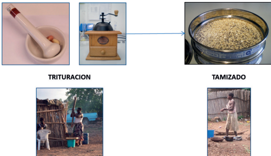
Figura 3.- Equivalencia de medios utilizados en el laboratorio y a escala local para la preparación del extracto coagulante.
