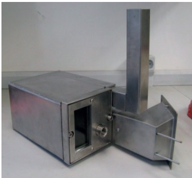
Cámara de combustión. Capacidad 2 litros.
