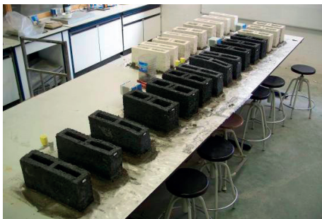
Figura 11. - Bloques elaborados utilizando CCA.
