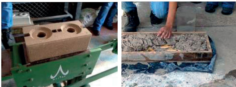
Figura 3.- Bloques de tierra compactada y placas.
