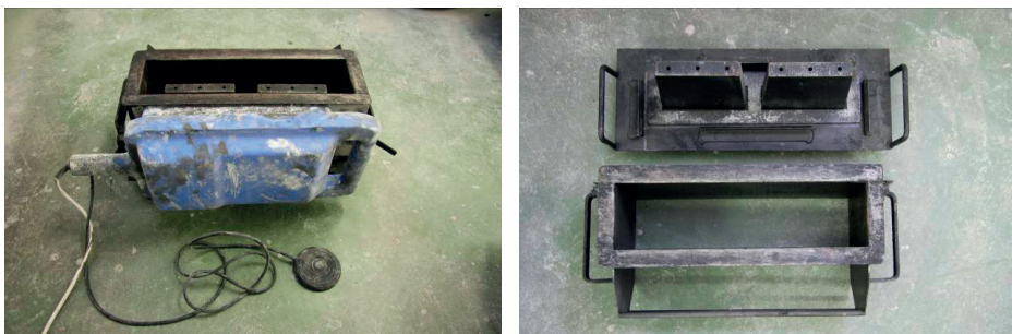
Figura 10.- Bloquera de vibrado portátil con alimentación mediante batería.
