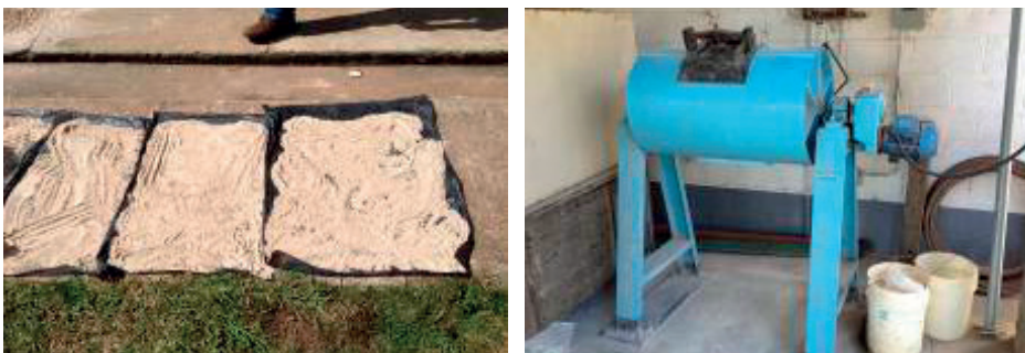
Figura 2.- Procedimiento de secado y molienda de las muestras de puzolana.
