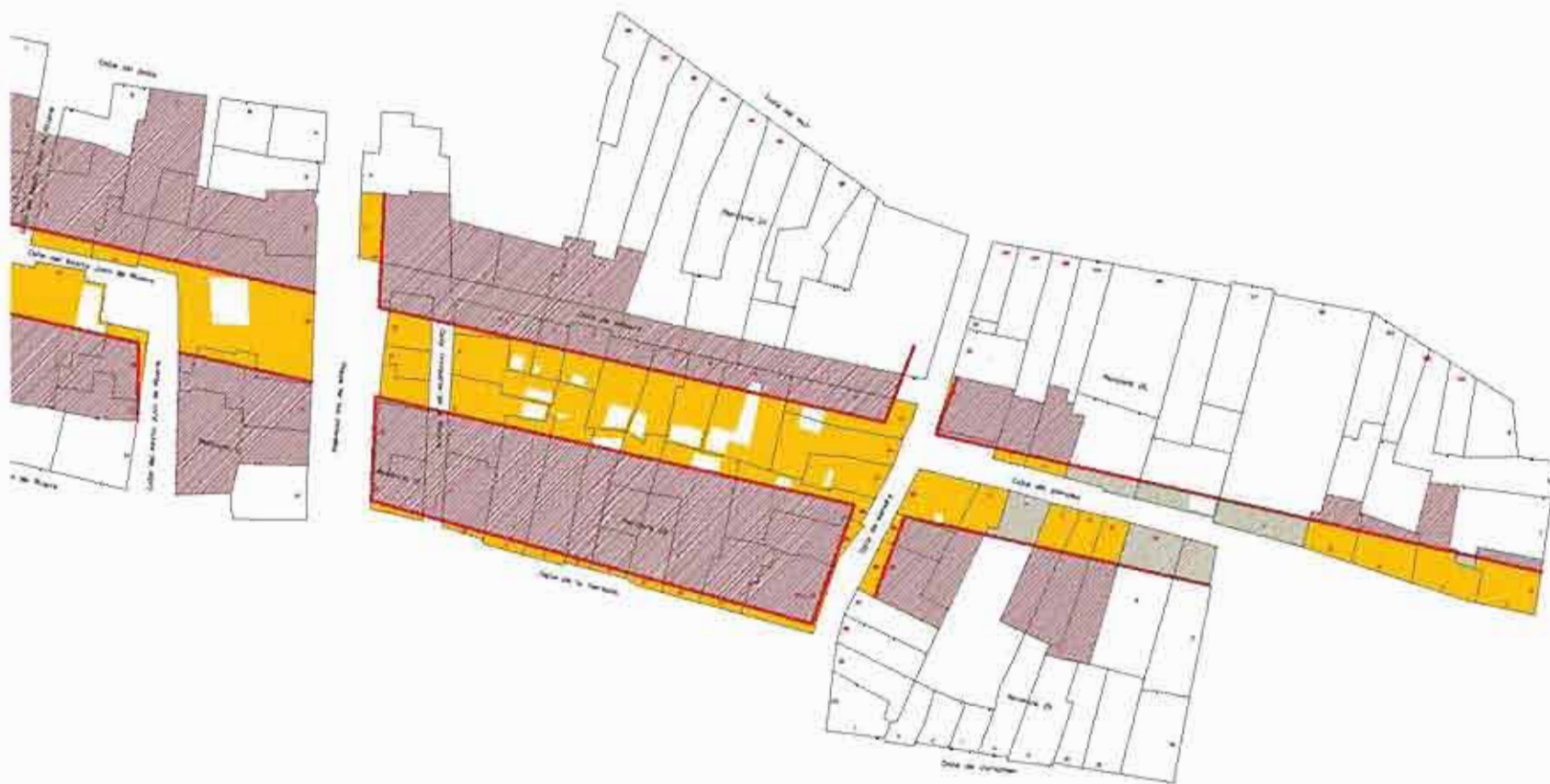
51. Restitución de nuevas alineaciones y antiguas manzanas del proyecto de apertura de la calle de La Paz de L.FERRERES y J.ARNALU. Escala 1: 1.500. Elaboración propia
