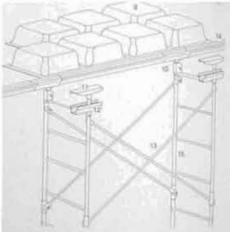
16. Andamio para el encofrado de forjados bidireccionales de hormigón armado.
