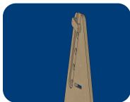
Fig 74. Tope atornillado en la estructura del perchero. Elaboración propia.
