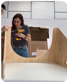
Fig 85. Atornillar cabineos del refuerzo. Elaboración propia.
