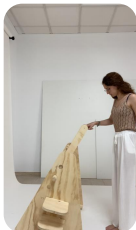
Fig 101. Comprobación a vuelcos. Elaboración propia.
