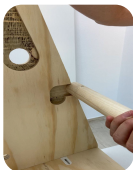
Fig 170. Colocación del palo de refuerzo. Elaboración propia
