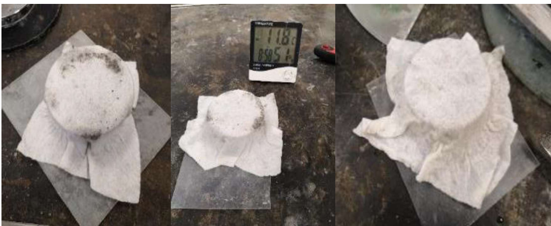
Figura 20. Protección de muestra con tela húmeda.
