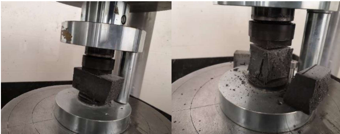
Figura 24. Ensayo a compresión.
