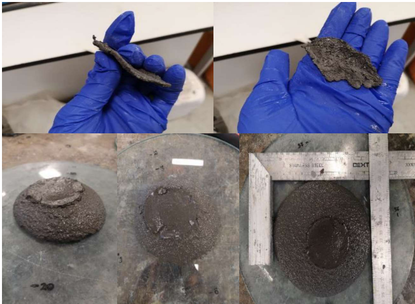
Figura 19. Lámina superficial en estado de solidificación (costra).
