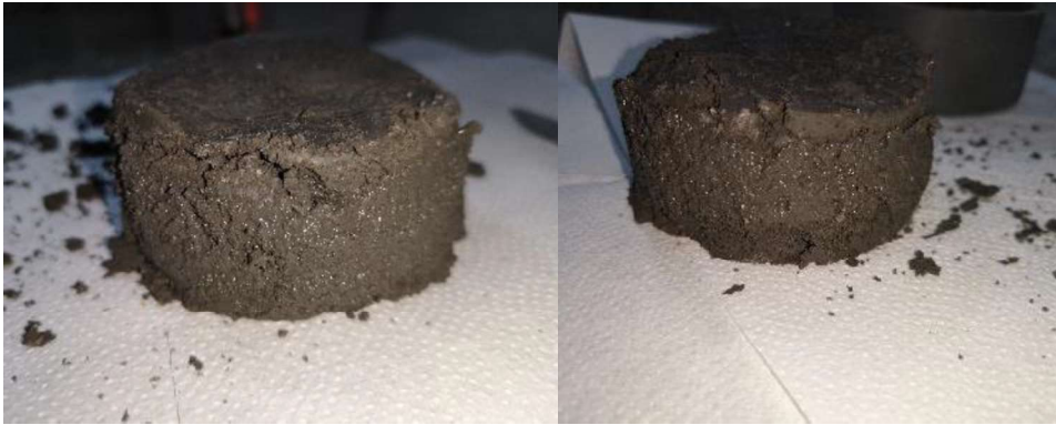
Figura 56. Muestras con falso fraguado. Izq. M6 RI-S-90NG – M6 – Der. M7 RI-S-20HExMC.
