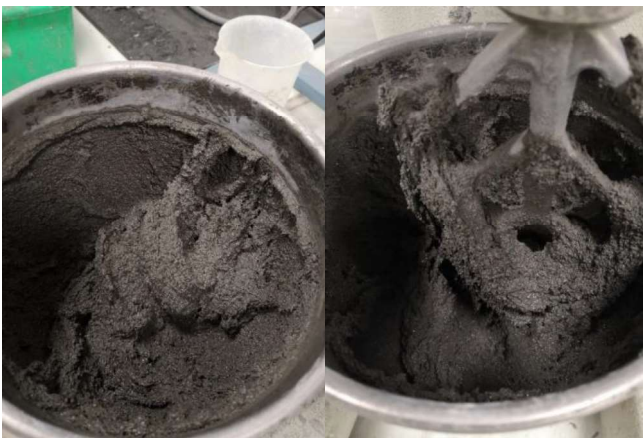
Figura 60. Muestras elaboradas con superplastificante VP-MC-Perma-71 (forma líquida).
