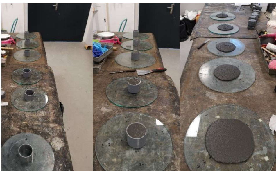
Figura 14. Ensayos con amasado único y prueba de Mini Slump.
