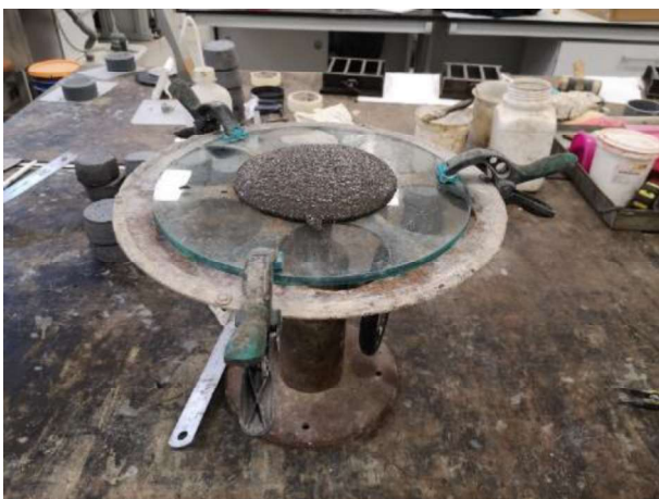
Figura 13. Ensayos con amasado continuo y mesa de sacudidas.
