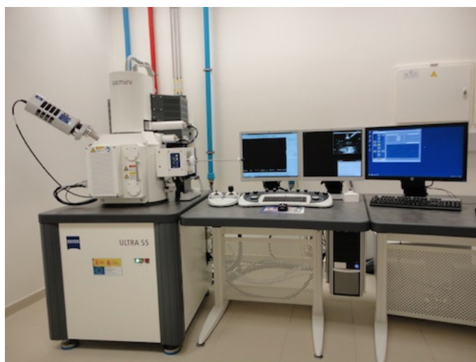
Fig. 4. 10. Microscopio electrónico de barrido de emisión de campo (FESEM, Ultra 55 ZEISS).
