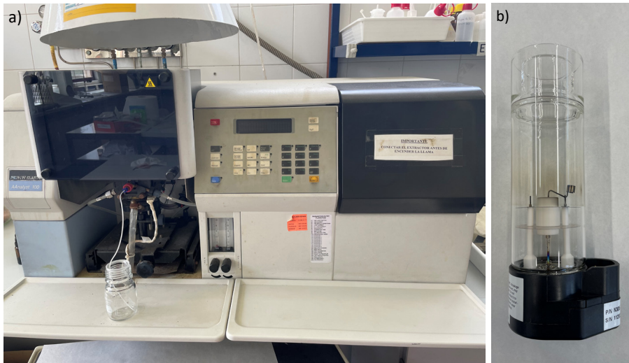
Fig. 4. 11. Espectrómetro de absorción atómica (Perkin Elmer Aanalyst 100) (a). Lámpara de cátodo hueco (b).
