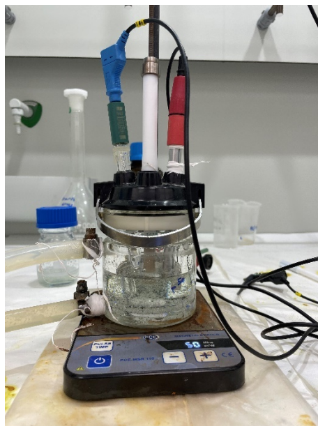
Fig. 4. 15. Celda electroquímica estándar de tres electrodos con camisa calefactora.
