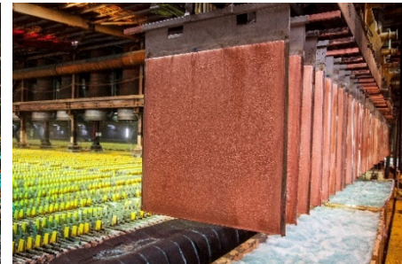
Cátodos de cobre
