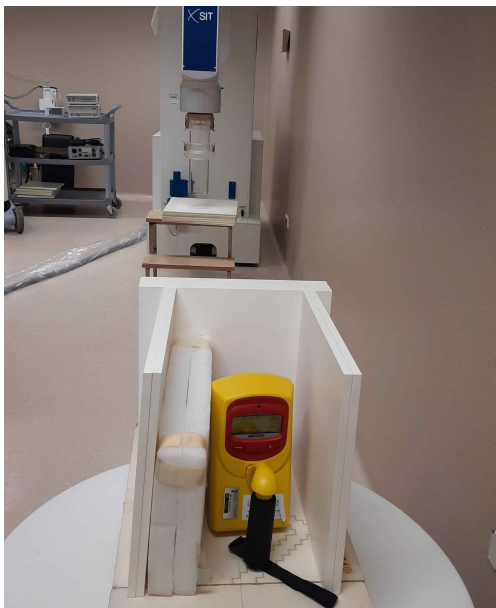
Figura I.10: Detector INOVION 451 de Fluke Biomedical, USA. Mesures de dosi perifèrica per a un LIAC HWL de Sordina, a 3 m del feix de radiació a l'Hospital La Fe de València.
