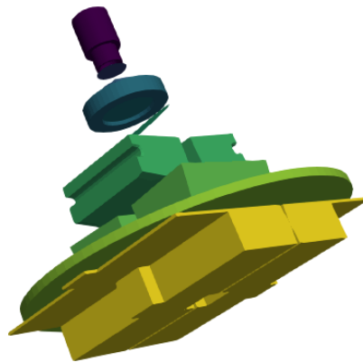
Figura II.6: Geometria completa de l'accelerador Varian Clinac 2100 C construït a partir dels plànols cedits per la companyia Varian per a propòsits d'investigació.
