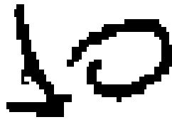
Figura 5.14: Fallo durante la agrupación, como se puede ver el el final de la base de 1 y el principio del 0 están dentro del ROI del carácter adyacente.
