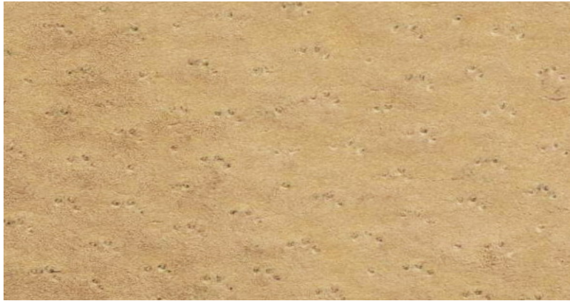
Fig. 50: Lado carne de un cuero porcino donde se aprecian los orificios de los folículos pilosos agrupados de tres en tres.
