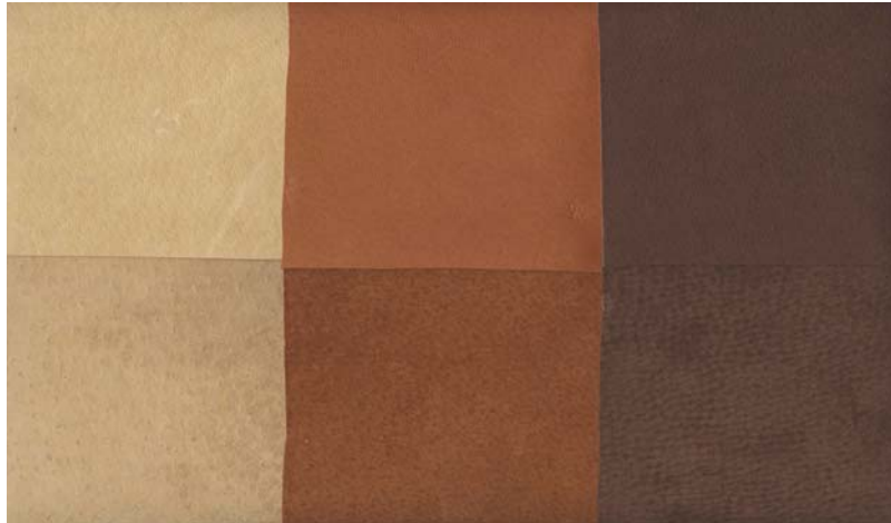
Fig. 49: Cueros de cerdo. De izquierda a derecha y de arriba abajo: claro flor, medio flor, oscuro flor, claro carne, medio carne y oscuro carne.
