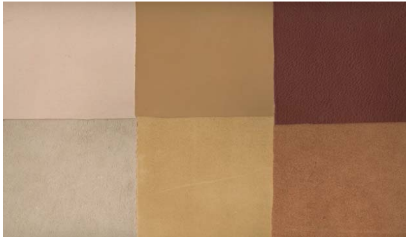
Fig. 52: Cueros de vaca. De izquierda a derecha y de arriba abajo: claro flor, medio flor, oscuro flor, claro carne, medio carne y oscuro carne.
