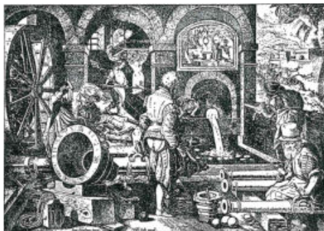
Fig. 1- Fonderia del XVI secolo per cannoni di bronzo con il forno (Singer et al. 1963, rist. 1968)
