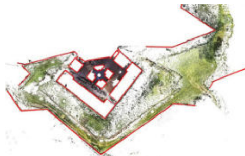
Fig. 4- Restituzione grafica a partire dalla nuvola di punti (Giuseppe Di Gregorio, 2022)
