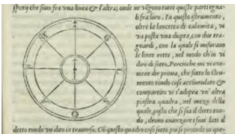
Fig. 5- Criteri e strumenti per disegnare: il 'Bossole' (Lanteri, 1557, II: pp. 55, 79)
