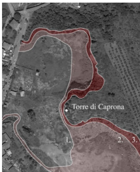
Fig. 4- Spostamento del profilo di cava nel tempo (fase 1-1954; fase 2-1988; fase 3-2021) (elaborazione grafica degli autori)
