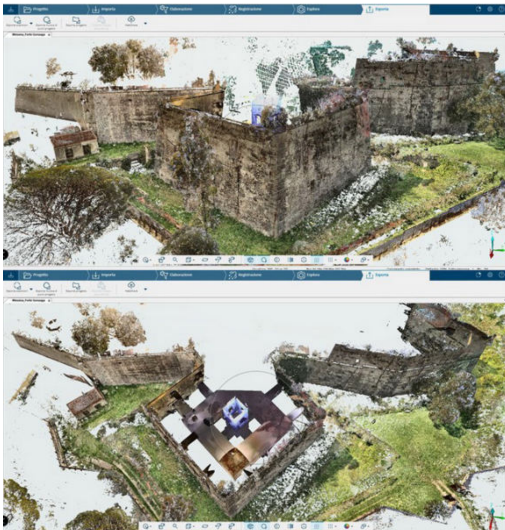
Fig. 3- Due immagini della nuvola di punti da due punti di vista a quota differente sulla stessa verticale, in alto il sistema dei bastioni, in basso il nucleo centrale al piano terra con il sistema delle volte (Giuseppe Di Gregorio, 2022)
