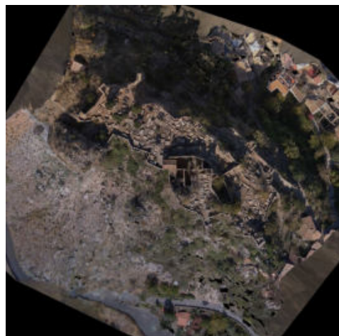
Fig. 3- Ortoimmagine del rilievo fotogrammetrico digitale della struttura. (elaborazione grafica Ing. Dario Caracci)
