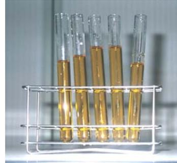
**Figura A.2.14.- Muestras de diluciones de  $\text{NiSO}_4$  y  $\text{K}_2\text{Cr}_2\text{O}_7$**
