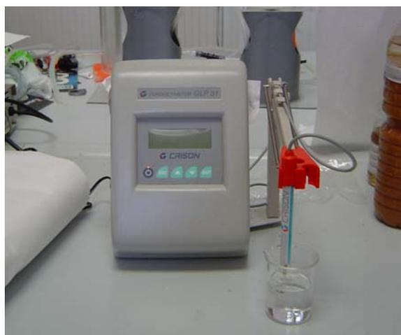
**Figura A.2.12.- Conductímetro CRISON GPL 31. Utilizado para la determinación de conductividades durante el periodo investigador**
