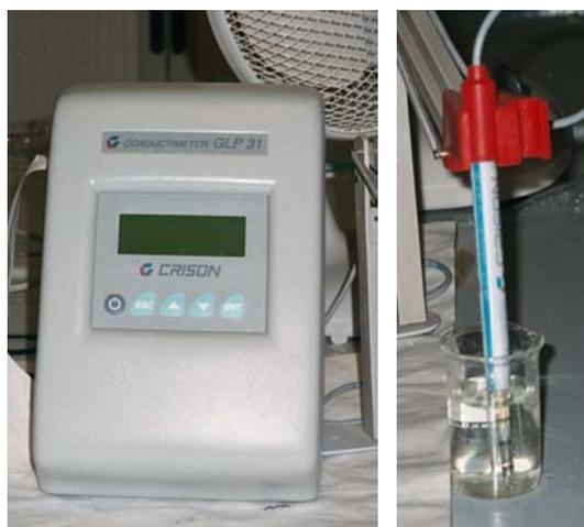
Figura 21.1.- Conductímetro CRISON GLP 31 y sonda.
