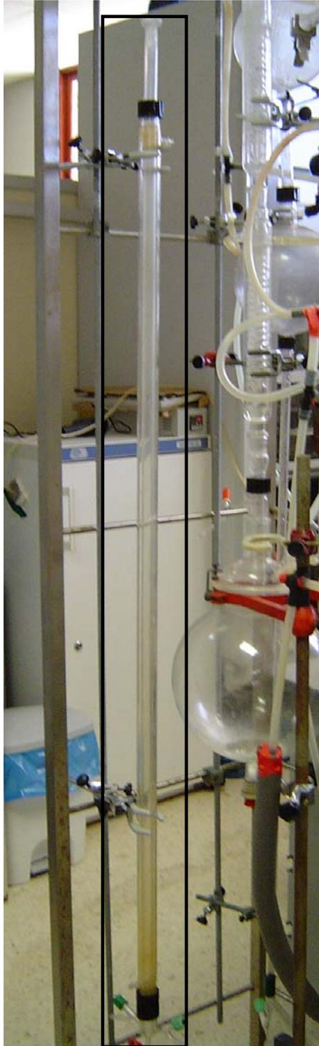
**Figura A.2.3.- Detalle del intercambiador de tubo recto vertical empleado en la configuración MEPA #1. Doble tubo cilíndrico concéntrico sin el aislamiento térmico**
