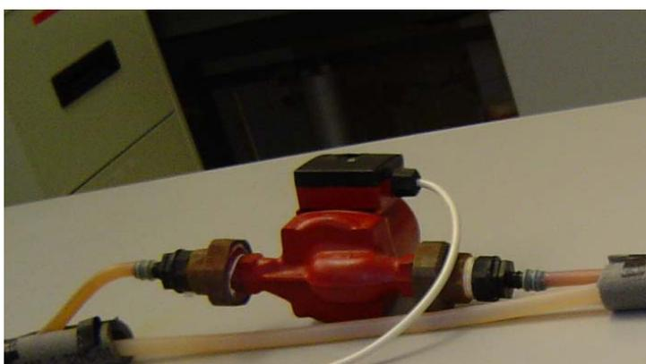
**Figura A.2.11.- Bomba de impulsión de 60w para la recirculación del líquido de calefacción**
