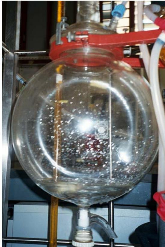
**Figura A.2.16.- Detalle del matraz colector. Se observa la caída continuada de destilado a consecuencia del funcionamiento del MEPA durante la realización de la fotografía**
