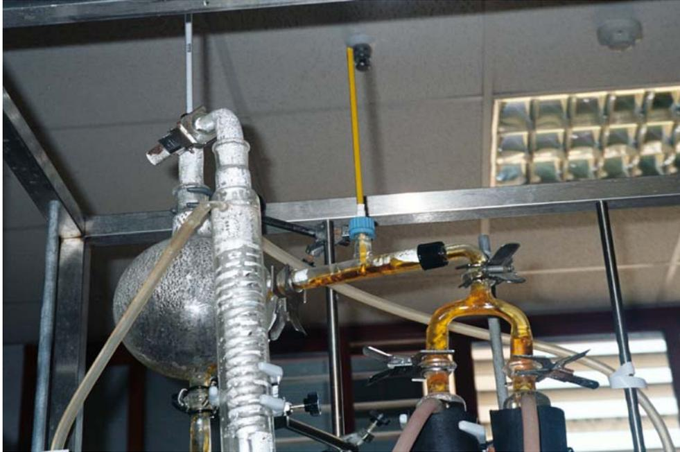
Figura A.2.8.- Detalle del fenómeno de condensación. Se observa la condensación del destilado en el serpentín refrigerador del MEPA #2
