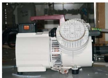
Figura 18.4.- Bomba de vacío KNF NEUBERGER N 035.3.
