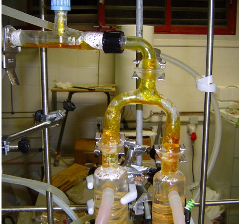
Figura A.2.6.- Detalle de la parte superior del MEPA #2. Se muestra la salida de la mezcla líquido vapor desde el intercambiador de doble columna en espiral hacia los matracos de expansión
