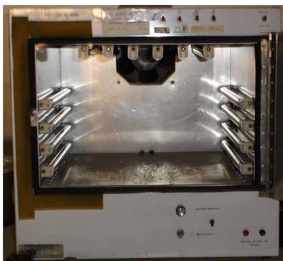
Figura VII.2. Motorreactor multilamparas. Las lámparas tienen un envoltente filtrante que permite irradiar a \lambda_{\max} = 254, 300 y 350 nm.
