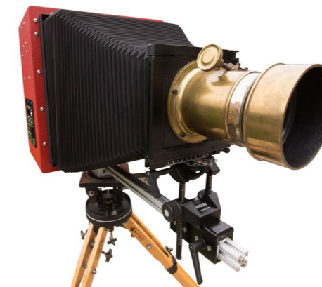
Fig.25 LS911, primera cámara digital de fotograma completo 8x10.
