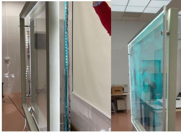
Fig. 3. Iluminación Lightboard mediante tiras de luces LEDs y encapsulado exterior
