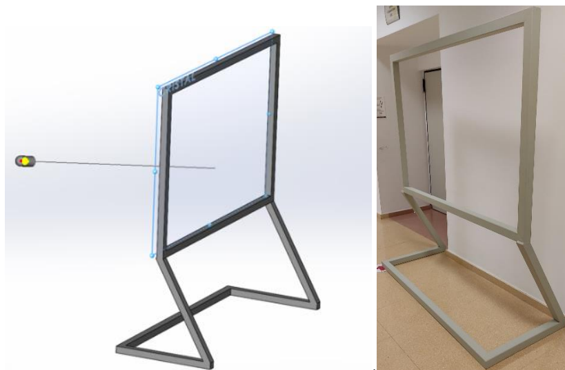
Fig. 2. Diseño y fabricación de estructura soporte de la pizarra Lightboard.
