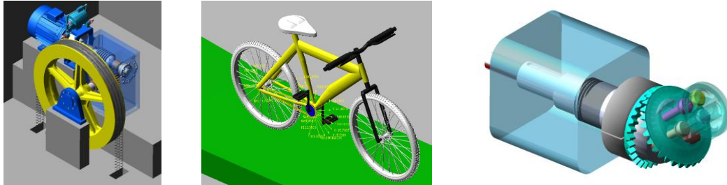
Fig. 1. Modelo de un grupo reductor de un ascensor, de transmisión de cadena en bicicleta y de bomba hidráulica de pistones con motor eléctrico.
