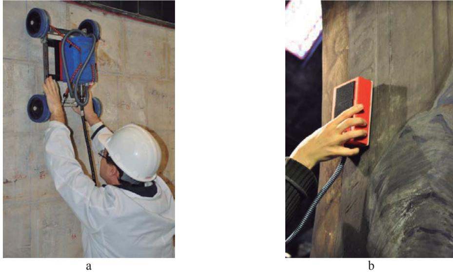
Figura 2: Antena georradar montada en posicionador o carrito, y antena desplazada “a mano alzada”.
