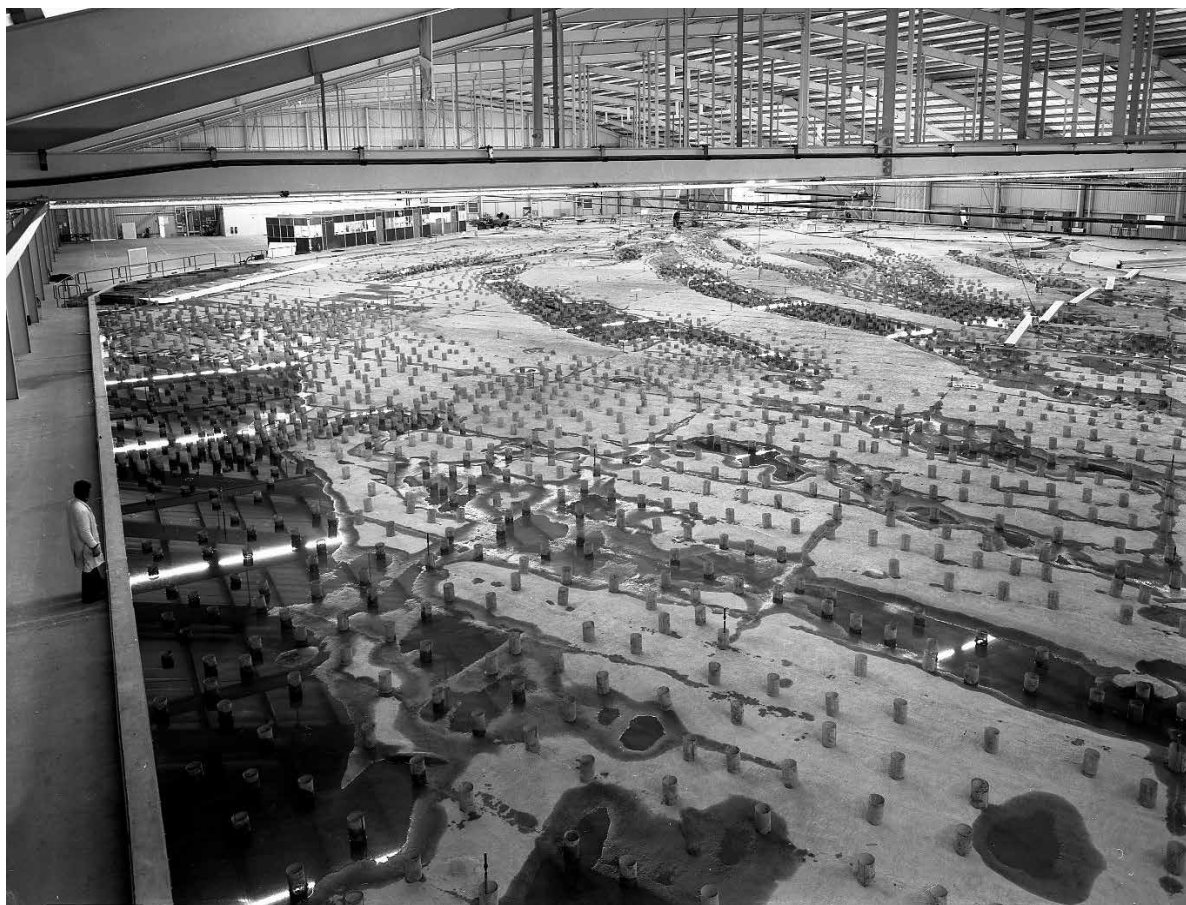
Figura 15. Modelo a escala horizontal 1:1000 y vertical 1:100 del estuario exterior del Támesis para estudiar los impactos de un aeropuerto que se propone construir en Maplin Sands. El edificio de 75×32 metros no tiene pilares. Las docenas de pequeños cilindros del fondo marino de la maqueta se utilizaron para introducir turbulencias en el flujo. (Imagen: cortesía de HR Wallingford)
