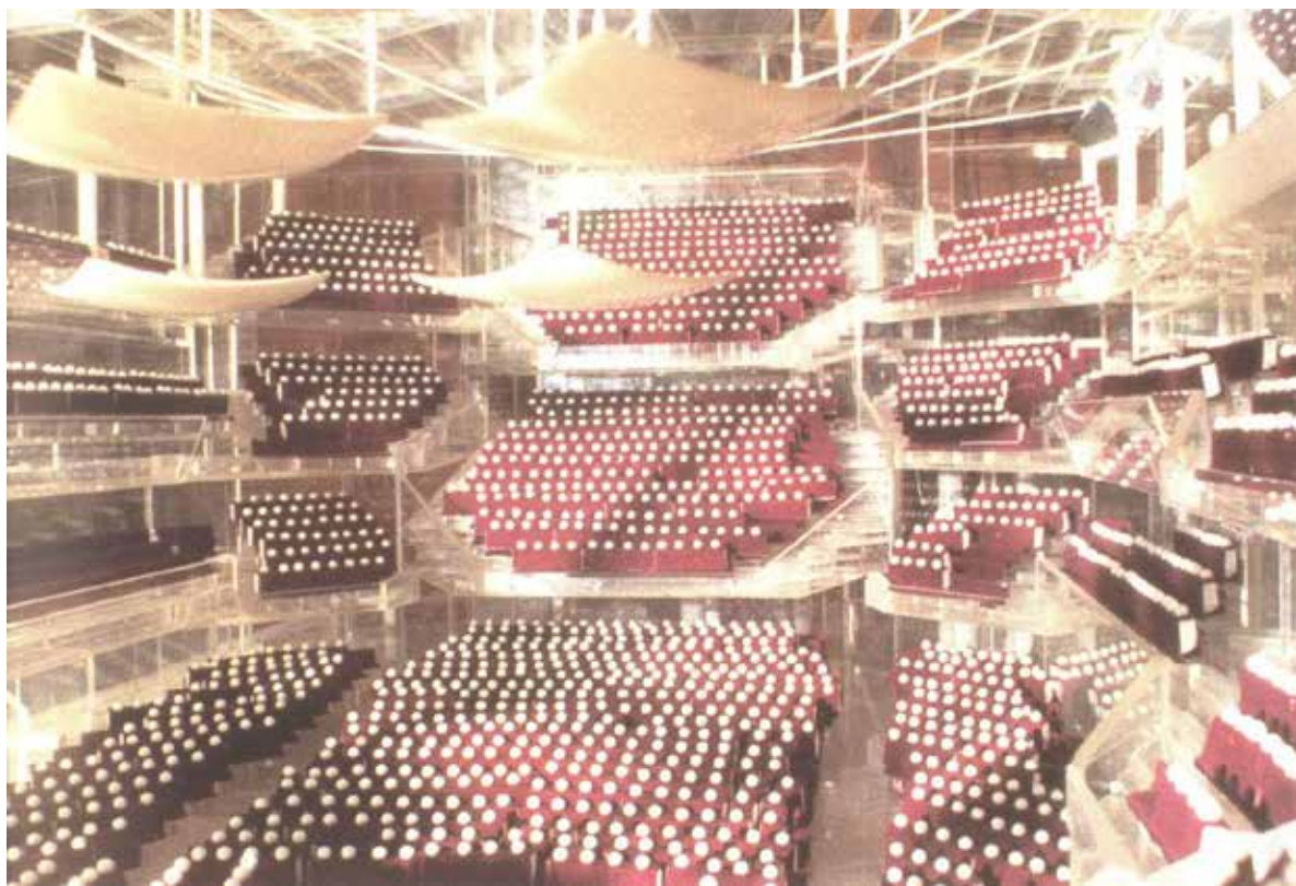
Figura 18. Modelo a escala 1:50 del Bridgewater Hall, Birmingham, Reino Unido. Los puntos blancos están hechos de un material absorbente para simular a las personas sentadas en sus asientos. (Imagen: Sobre Arup & Partners)
