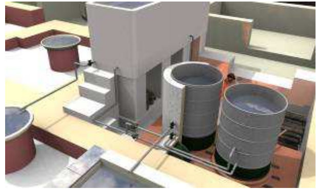
Figura 8. Sistema de caldeoamiento del agua en los baños romanos de Iluro.
