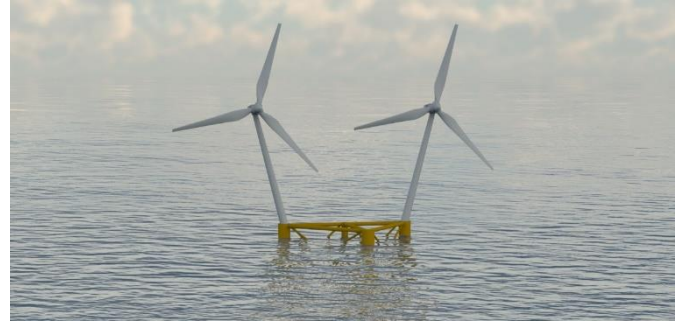
Figura 1. Plataforma eólica flotante offshore W2Power. Fuente: EnerOcean S.L.
