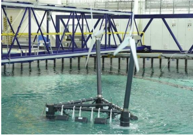
Figura 2. Prototipo a escala 1:40 del concepto W2Power. Ensayos en el tanque de olas FloWave, Edimburgo. Fuente: EnerOcean.
